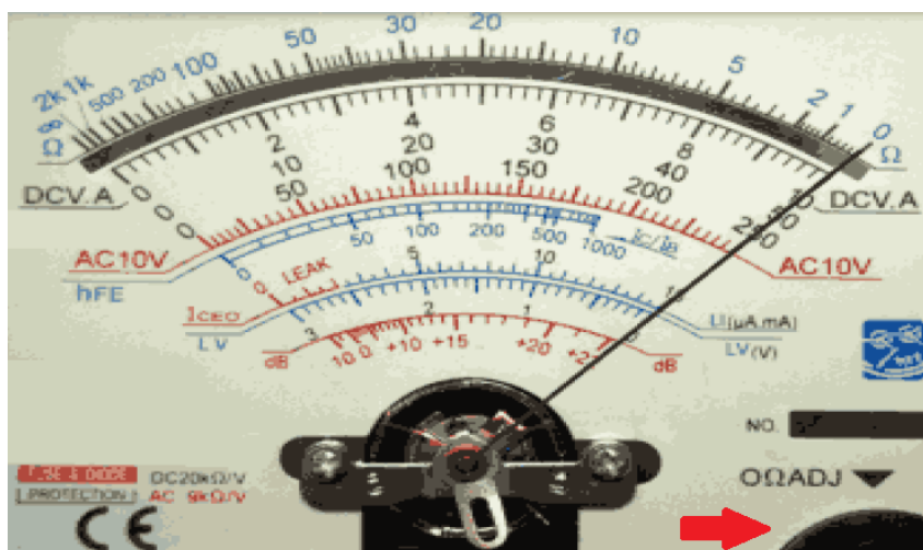
Hình 1.2 Chập hai kim lại và điều chỉnh để có 0 Ω
