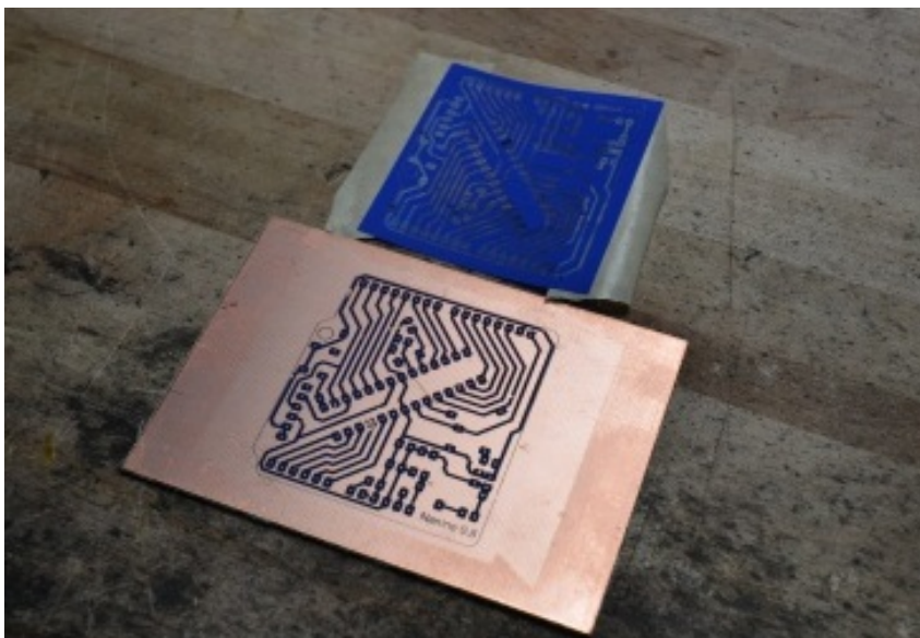
Hình 5.2 In mạch lên giấy bóng rồi chuyển qua tấm mạch đồng
