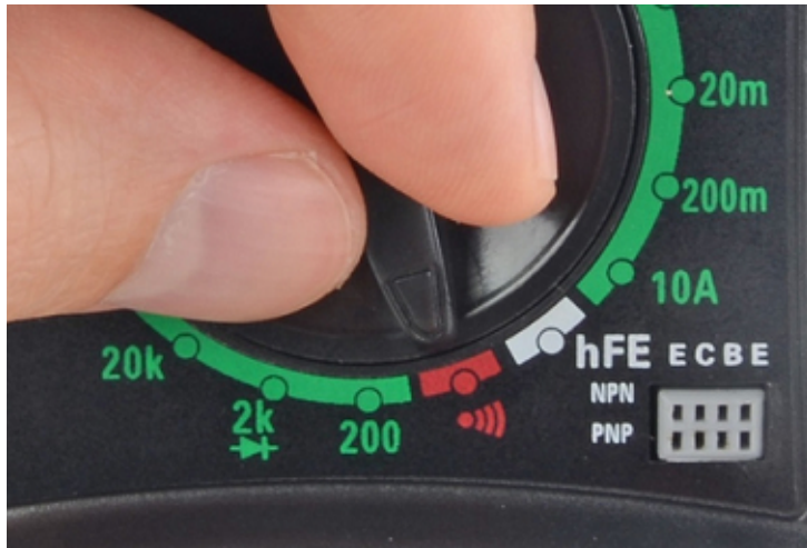
Hình 1.12 Đặt núm chỉnh về vị trí đo thông mạch.
