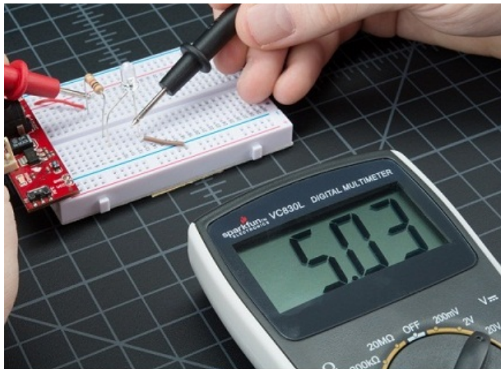
Hình 1.9 Đo điện áp rơi trên các thành phần mạch.
