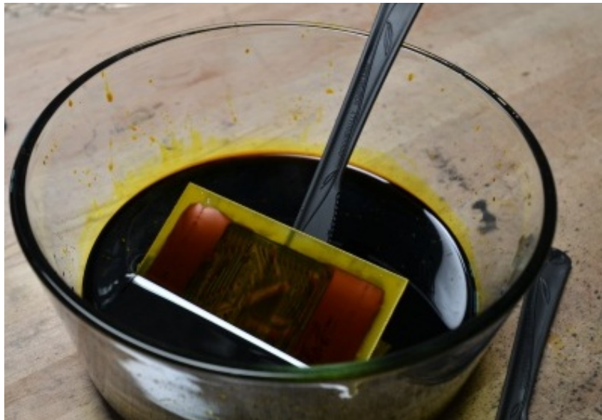
Hình 5.3 Ngâm mạch đã vẽ vào trong dung dịch hóa chất
