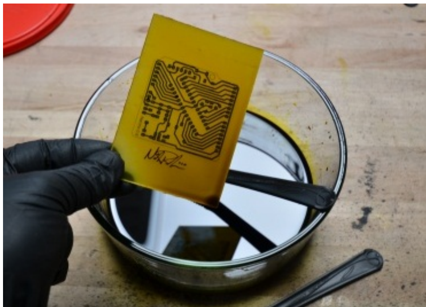
Hình 5.4 Hóa chất ăn mòn vùng đồng không được vẽ
