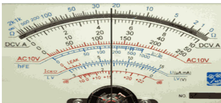
Hình 1.6 Nếu chọn thang 5V thì đọc theo vạch chia 50 và kết quả là 2,4V.
